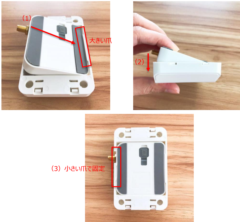
図 5-2 ASR-P37U の取り付け
