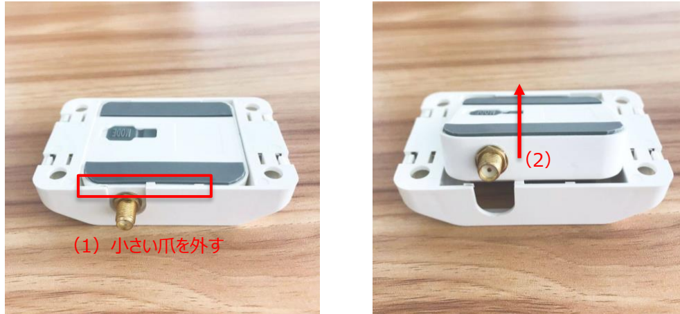
図 5-3 ASR-P37U の取り外し
