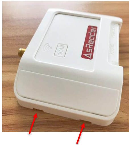
図 5-6 カバー爪の外し方
