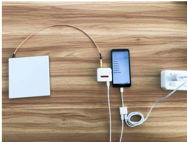
図 4-2 Android 端末の接続（方法 1, Android 端末を充電しながら使用する場合）
