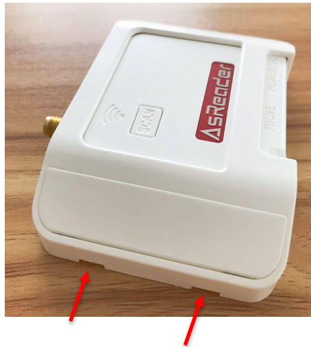
図 5-6 カバー爪の外し方
