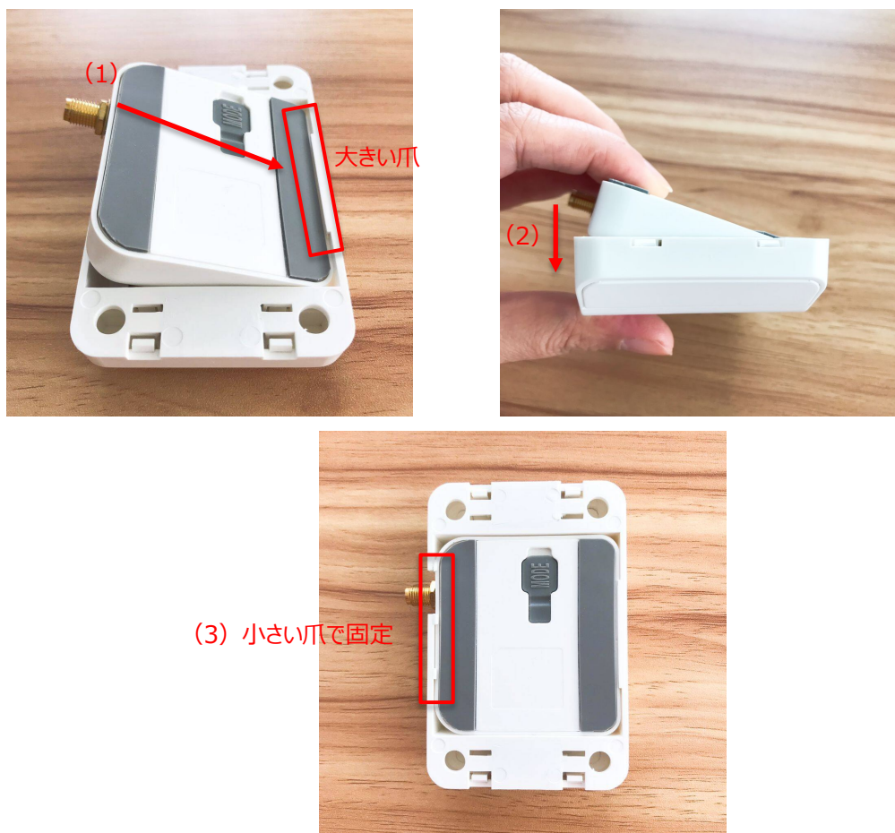
図 5-2 ASR-P37U の取り付け
