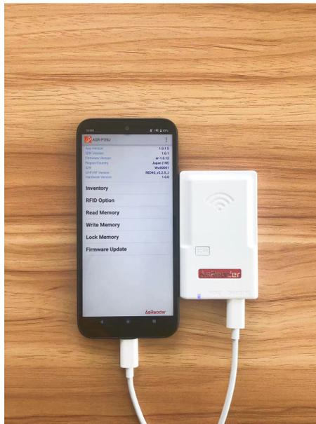
図 4-3 Android 端末の接続（方法 2）
