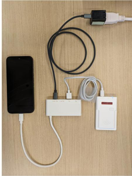
図 4-2 Android 端末の接続（方法 1, Android 端末を充電しながら使用する場合）
