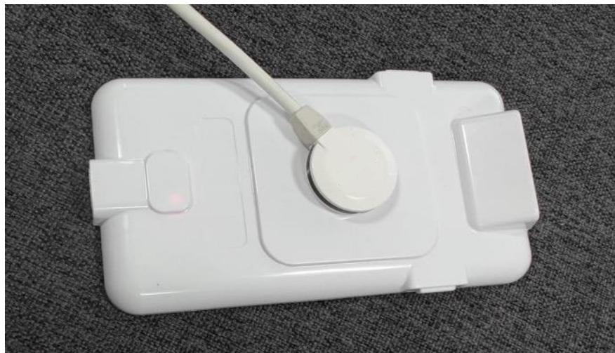
Android 端末と接続している場合は AsReader と Android 端末のバッテリーを同時に充電します。
