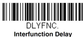
この遅延を削除するには、まずファンクション間の遅延バーコードを読み取り、次に数字バーコードの 0 を読み取って、Save を読み取ることで設定されます。
