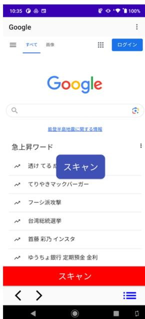
スキャンボタンは左図のようにメイン画面上に表示されます。A24D が接続されている時にスキャンボタンをタップすると、レーザーが照射され、バーコードや QR 等を読むことができます。また、ボタンの表示位置をドラッグすることで自由に動かすことができます。
